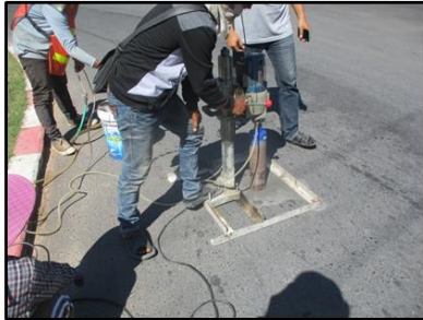
Coring ตรวจสอบความหนาผิวทางแอสฟัลต์คอนกรีต
